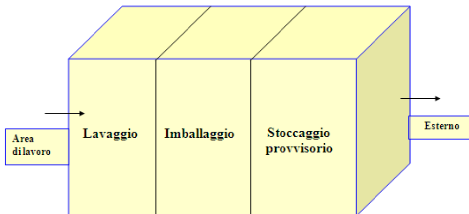
Figura 7.2-6: Unità di decontaminazione dei materiali (UDM)
